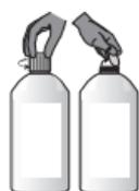
3) Oter le bouchon de protection de l'embout de la pompe.
